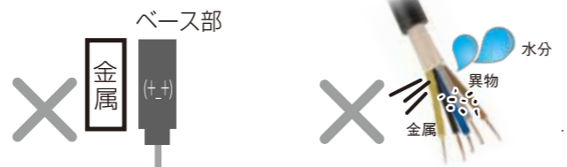
（図3）ベース部の金属対向 （図4）センサ内部に異物侵入
