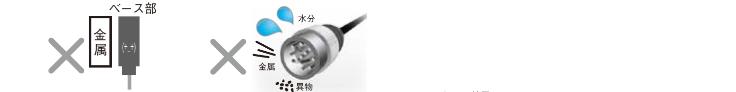
(図4) ベース部の金属対向 (図5) コネクタ末端から機器内部に異物侵入
