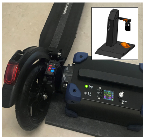
【電動キックボード用に36Vへカスタムした事例】 ベース部に表示器や電源を一体化。充電ステーションの事例もございます。
