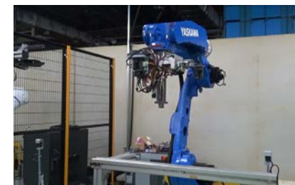
産業用ロボットのハンド部の 完全ワイヤレス化事例
