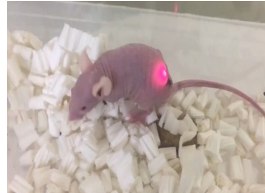
光免疫療法に関する LED 点灯実験 (マウスへ埋め込んだ極小 LED デバイスへワイヤレス給電)
