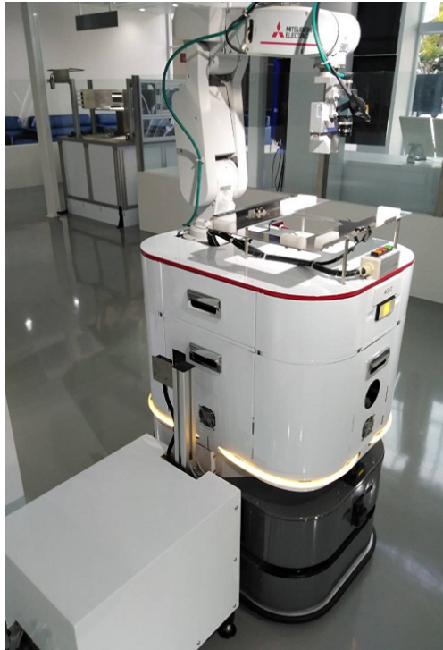
無機道走行型 AGV へのワイヤレス充電事例 (田辺工業様)
