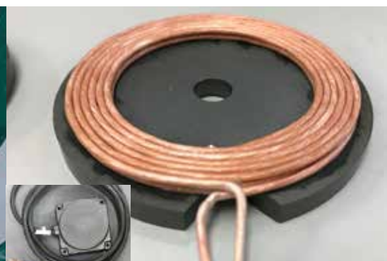
小型ヘッドでの PC 電源給電 (80W)
