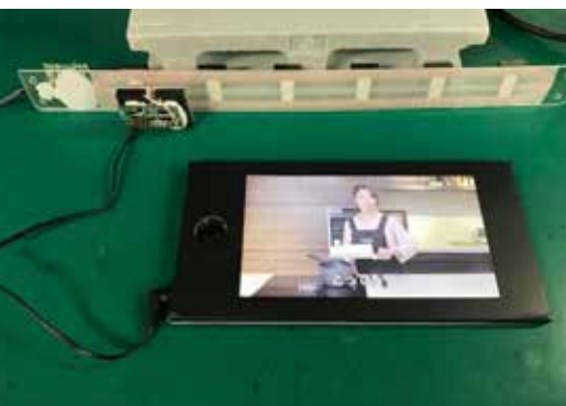
リニア形状でのタブレット給電 (10W)
