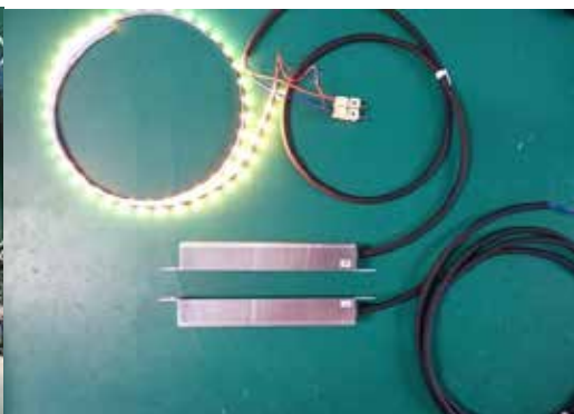
ドアへの給電 (10W+ 制御信号)
