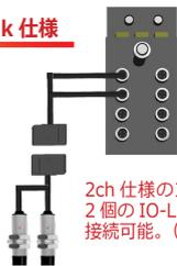
2ch 仕様のコンパクトリモートは、2個の IO-Link デバイスを接続可能。(2つの ID 管理)
