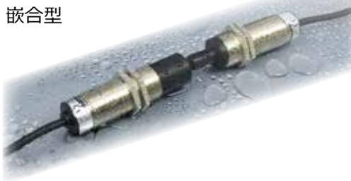
凹型のリモート部に凸型のベース部を差し込むだけでワイヤレスで給電します。嵌合タイプなので小型で24V1Aの大電力の防水接続が可能です。
