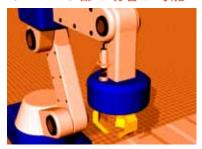
ロボットのハンド部分にリモートセンサを設置。異なるハンドに付け替えても近接センサからの信号を受信することが可能。
