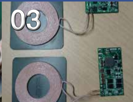
03 ワイヤレス給電用標準基板セット
