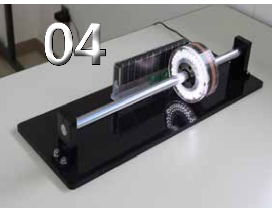
04 リニア形状からリング形状へのワイヤレス給電
