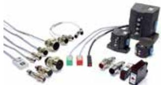
金属の対象物を検知する高周波発振型近接センサ、非金属などあらゆる物体の有無を検知する静電容量型近接センサ、赤外線またはレーザー光で長距離検出が可能な光電センサ、高精度な位置決めセンサとして加工機等に利用されているシングルまたはマルチのリミットスイッチを用意しています。またこれらセンサの多様なアクセサリもラインナップ。
