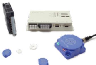
「もの」に取り付けた ID タグに様々な情報を書き込み、任意の場所に設置した ID アンテナでそのデータを読み書きします。「もの」と「情報」を一体化する ID システムは、自動化された量産システムから柔軟な多品種少量生産システムまで対応できるキーテクノロジーです。
