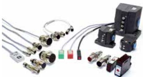
金属の対象物を検知する高周波発振型近接センサ、非金属などあらゆる物体の有無を検知する静電容量型近接センサ、赤外線またはレーザー光で長距離検出が可能な光電センサ、高精度な位置決めセンサとして加工機等に利用されているシングルまたはマルチのリミットスイッチを用意しています。またこれらセンサの多様なアクセサリもラインナップ。
